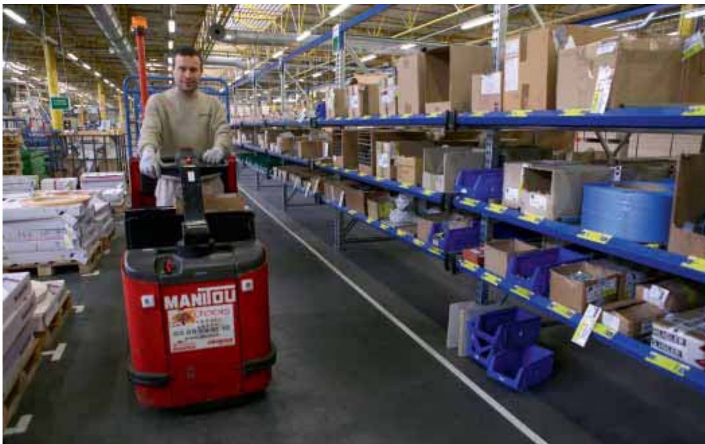
Deux 'supermarchés' ont été aménagés dans le département de production, un pour les pièces en métal et l'autre pour les pièces en plastique. Ils servent tous deux à approvisionner les lignes d'assemblage via un système Kanban.
